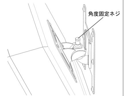
上下左右の角度を調整し、最適な角度で「角度固定ネジ」をしっかりと締めて、角度を固定してください。
